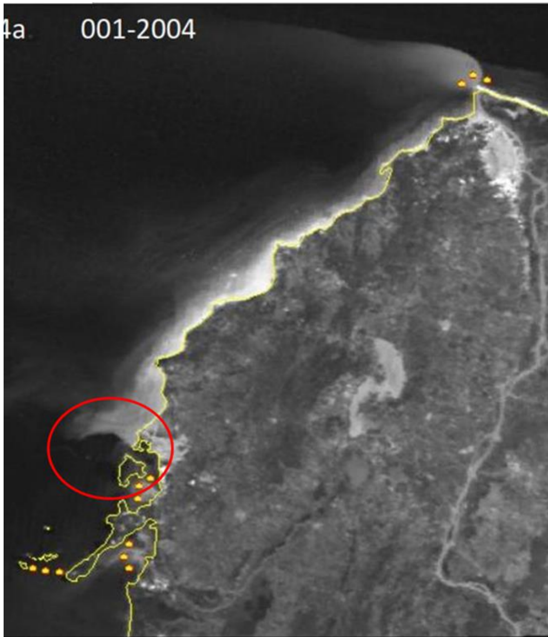
Figura 17-La Corriente de Panamá. frena en seco a la Deriva Litoral al norte de Tierra Bomba (ver círculo rojo). 37
