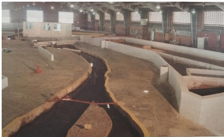
Figura 30-Modelo físico a escala del río Magdalena en el Laboratorio de Las Flores. Sector Puente Pumarejo – Bocas de Ceniza (1997) 85 .
